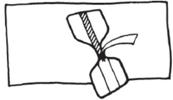
2. Positionieren Sie die untere Hälfte des Verstärkers etwas seitlich vom Mittelfalz der Zeitschrift, damit sie weiterhin problemlos geschlossen werden kann.
