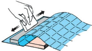
4. Das Schutzpapier (bzw. -folie) langsam unter der Klebefolie abziehen und die freiwerdende Klebefolie mit dem Buchraker zum Rand hin anreiben.
