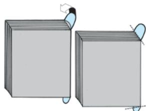
Papieretiketten sollten vor dem Folieren des Buches auf den Rücken geklebt und dann in einem Arbeitsgang mit der Schutzfolie oder den Schutzfolien-Zuschnitten für Signaturen überfoliert werden. Dabei sollte die Folie das Etikett oben und unten circa 1 cm überragen und links und rechts bis auf die glatten Flächen der Buchdeckel reichen, damit noch genug Überstand zum Befestigen bleibt.
