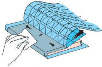
6. Die Folienüberstände an allen Ecken schräg abschneiden und am Buchfalz keilförmig ausschneiden.
