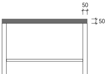
Abdeckfachboden Typ A bis C, Dicke 50 mm, aufliegend/außen bündig
